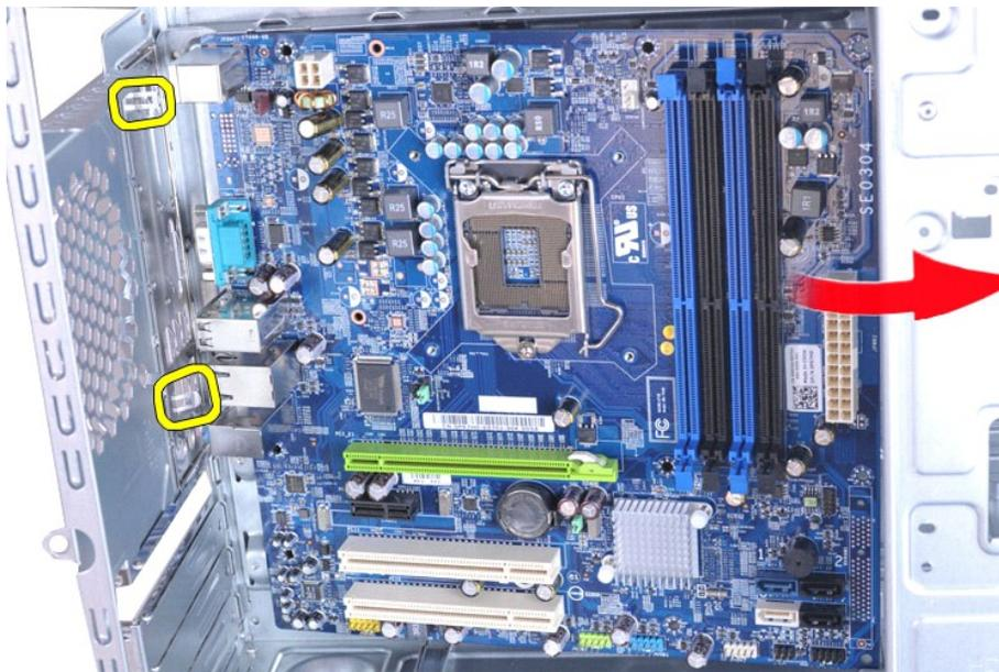
**⚠ 경고:** 시스템 보드를 장착할 경우 시스템 보드를 금속 램 아래로 미십시오. 시스템 보드를 아래로 누르면(시스템 보드가 금속 램 위에 놓인 경우) 시스템 보드가 손상될 수 있습니다.
